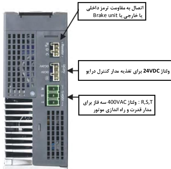
سوکتهای بالای درایو سری 400VAC
